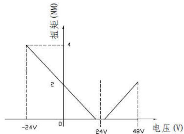
电压 - 扭矩曲线图 (冷态条件下)
